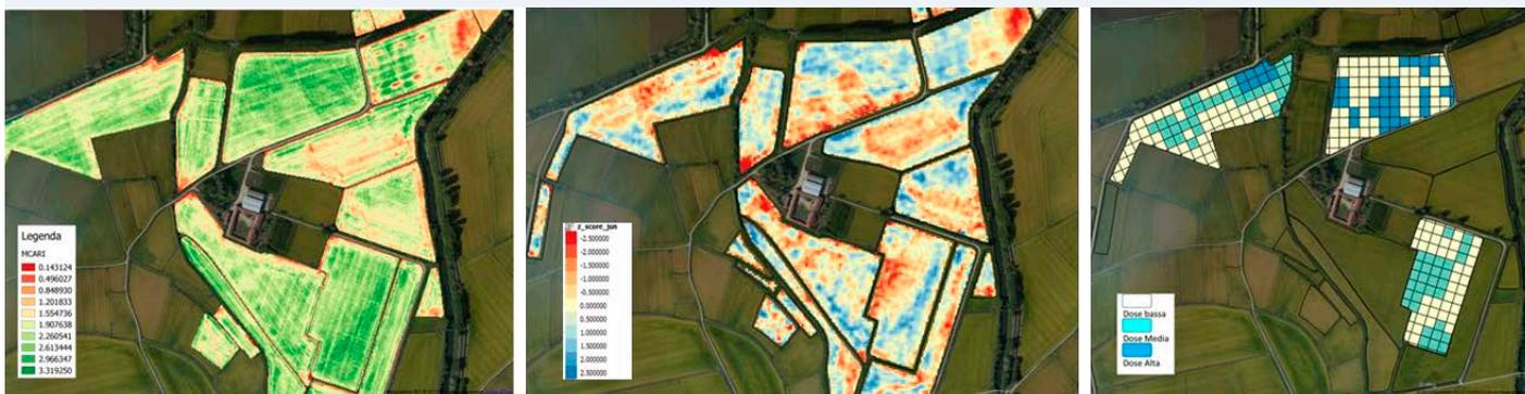
Nella mappa di prescrizione sono stati determinati 3 differenti livelli di fertilizzazione azotata: alta 55 unità, media 46 unità, bassa 37 unità.
